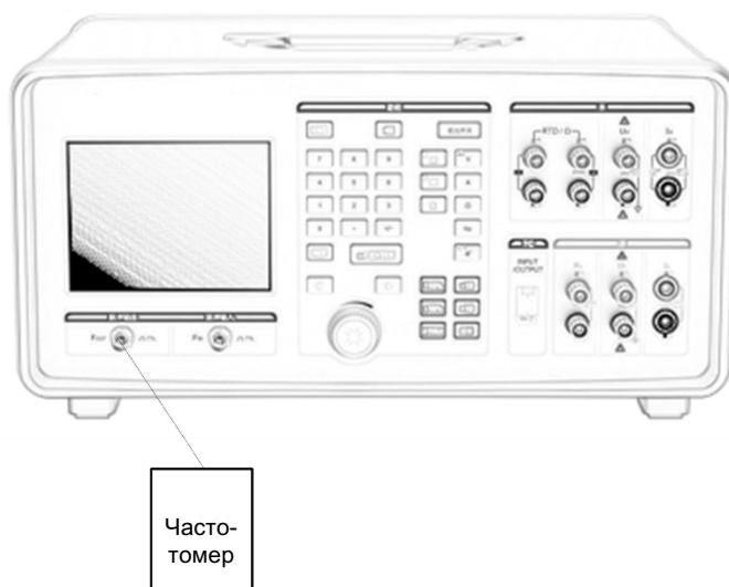
Рис. 5.9. Схема подключения вывода частоты КП5100
