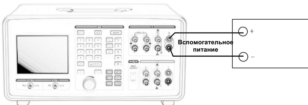
Рис. 5.11. Схема подключения КП5100 для режима Loop
