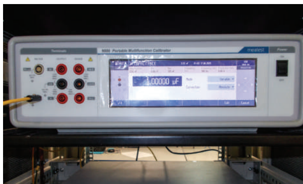
Рис. 17. Калибратор Meatest 9000 в режимах формирования фиксированных и произвольных значений электрической емкости
