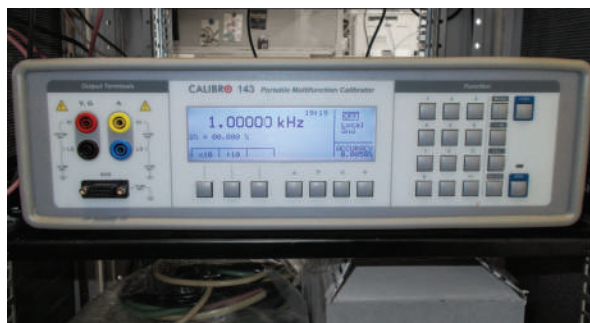
Рис. 10. Калибраторы Meatest 9000 и Calibro 143 в режиме формирования сигнала определенной частоты
