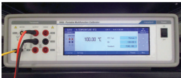
Рис. 13. Калибратор Meatest 9000 в режиме имитации термометров сопротивления
