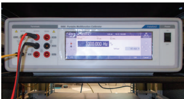
Рис. 10. Калибраторы Meatest 9000 и Calibro 143 в режиме формирования сигнала определенной частоты
