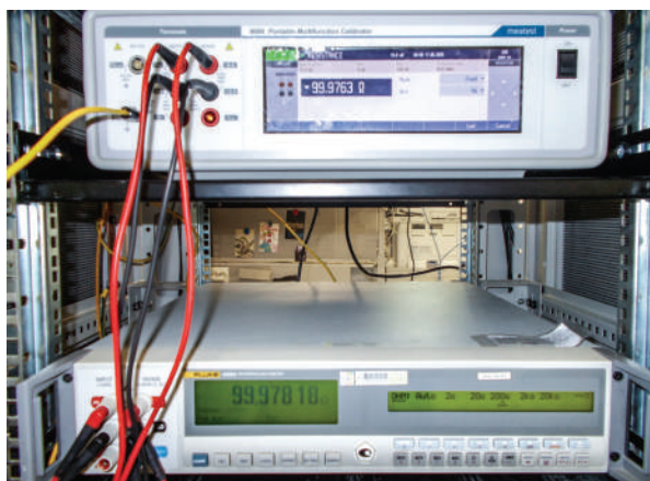
Рис. 15. Калибраторы Meatest 9000 и Calibro 143 в режиме формирования фиксированных значений сопротивления
