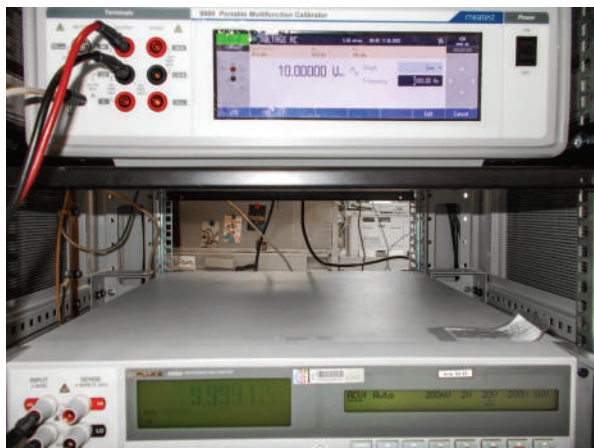
Рис. 4. Калибраторы Meatest 9000 и Calibro 143 в режиме формирования переменного напряжения
