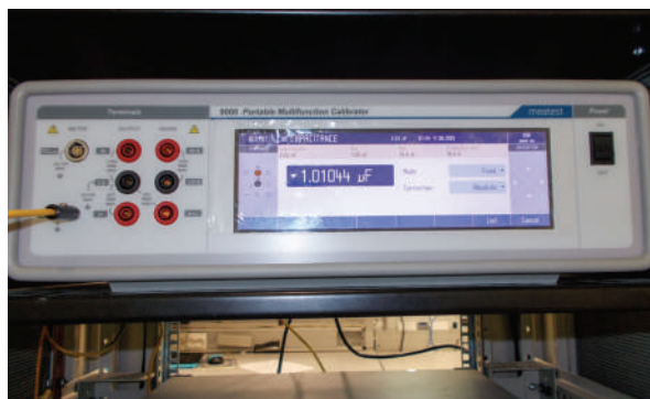
Рис. 17. Калибратор Meatest 9000 в режимах формирования фиксированных и произвольных значений электрической емкости
