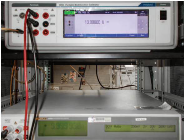
Рис. 2. Калибраторы Meatest 9000 и Calibro 143 в режиме формирования постоянного напряжения
