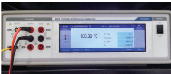
Рис. 12. Калибраторы Meatest 9000 и Calibro 143 в режиме имитации разности потенциалов термопар
